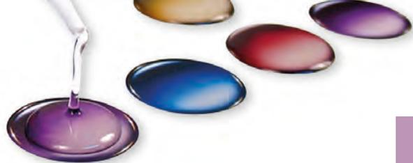
La fabricación del doming adhesivo consiste en depositar una cúpula de resina de poliuretano transparente sobre un impreso, que una vez secado en un horno se vuelve flexible e impermeable.
